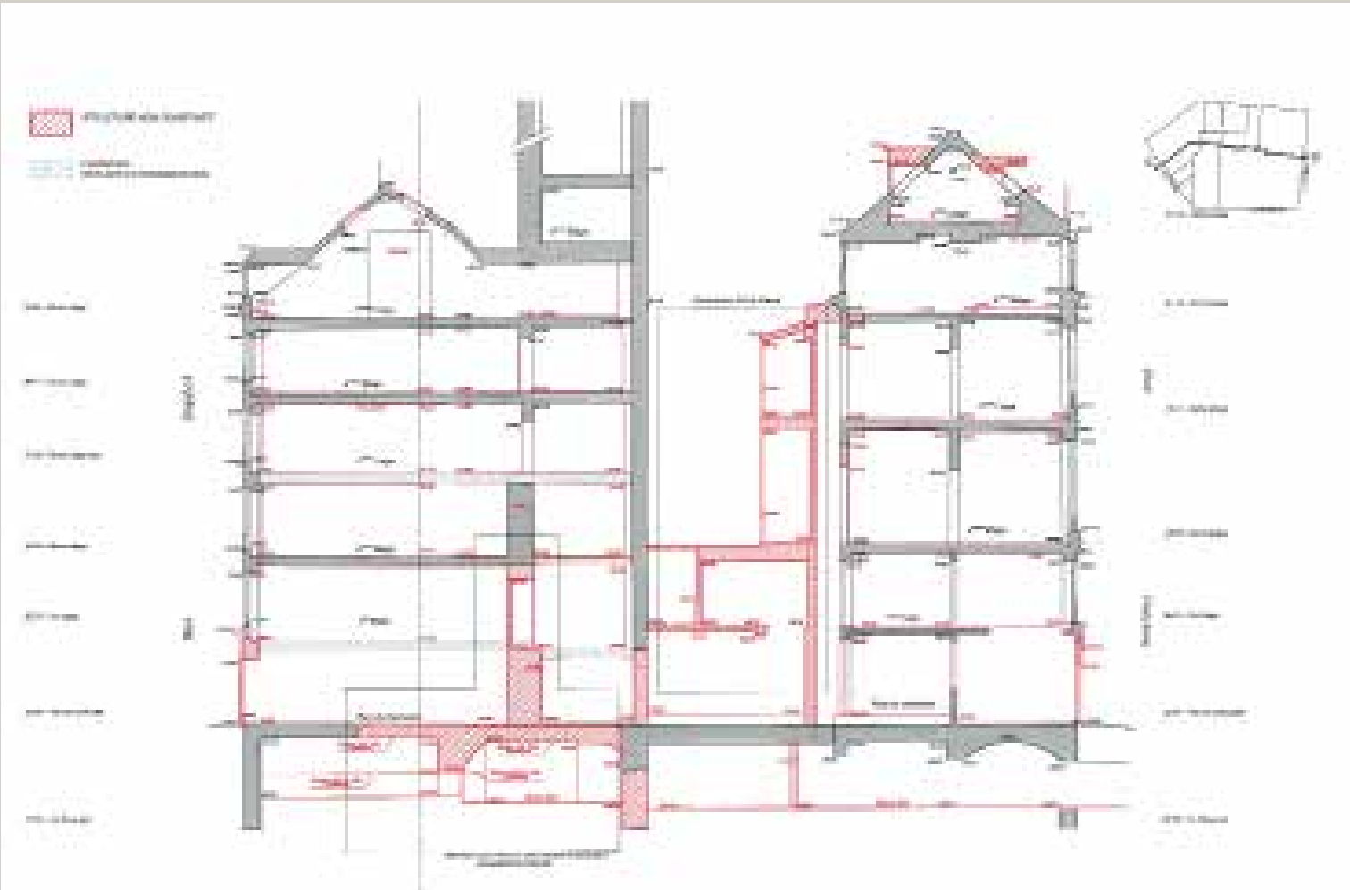
Coupe indiquant les démolitions et déplacements des planchers projetés (© Viguiers architectes).
